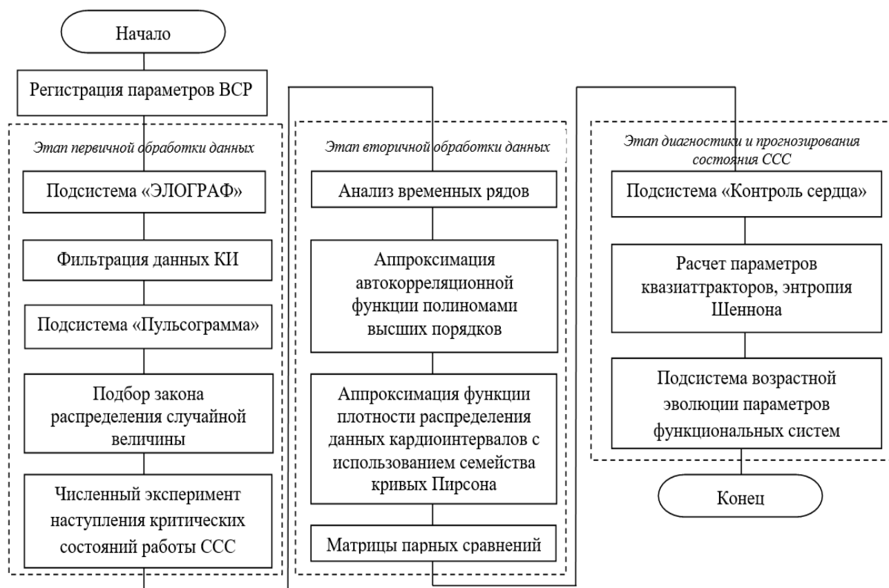
Рис. 7. Общий алгоритм обработки и анализа кардиографической информации в ИАСФКД
