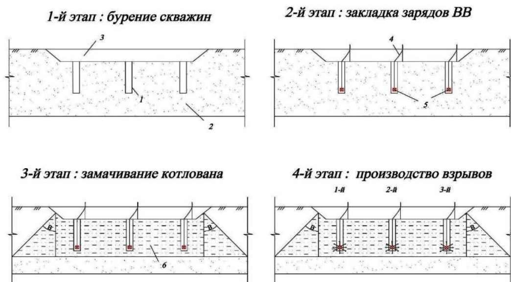
Рис. 14. Технологическая схема производства взрывных работ с размещением зарядов ВВ в скважинах до замачивания грунтов. 1 – дренажно-взрывные скважины; 2 – уплотняемый массив грунта; 3 – котлован; 4 – детонирующий шнур (ДШЭ-12); 5 – заряды ВВ; 6 – замоченный массив грунта.
