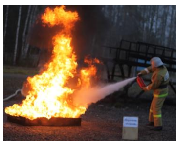
Рисунок 12 – Образование «огненной сферы» при подаче огнетушащего порошка в зону горения (промышленные испытания)
