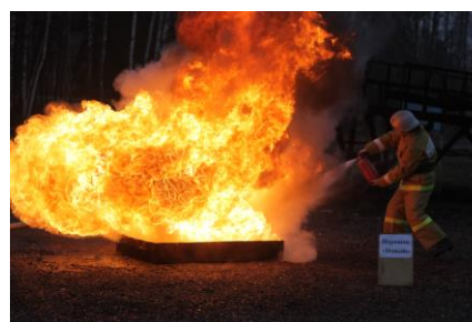
Рисунок 12 – Образование «огненной сферы» при подаче огнетушащего порошка в зону горения (промышленные испытания)
