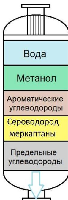
Рисунок 1 – Схематическое расположение адсорбированных компонентов природного газа в адсорбере УПГТ
