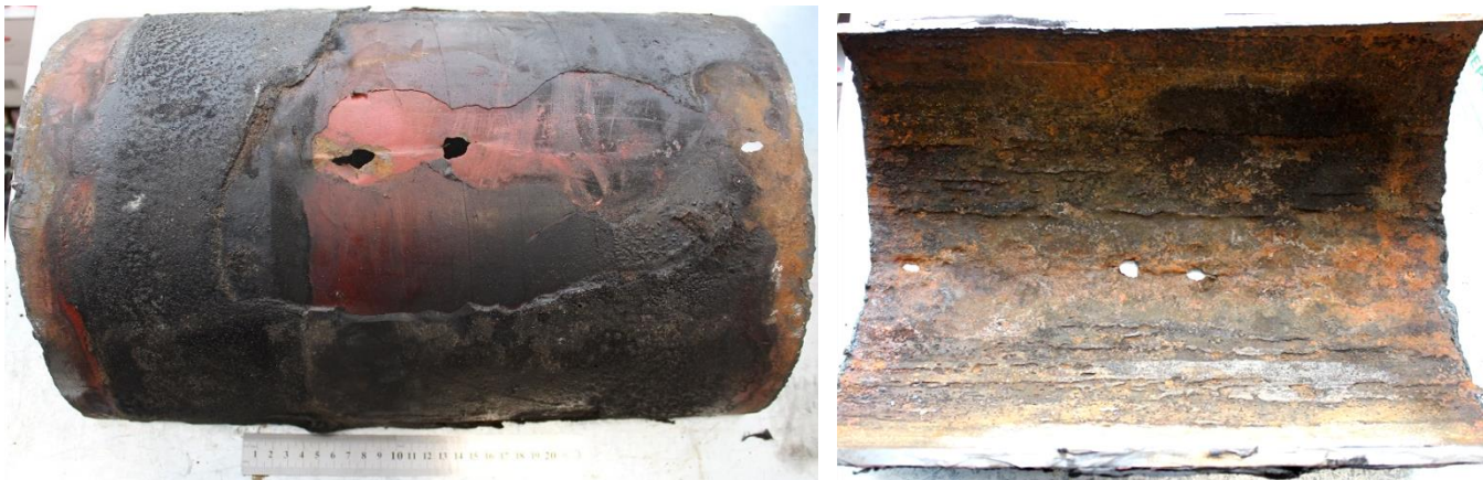
Рисунок 2 - Внешний вид фрагмента трубы из стали марки 13ХФА после эксплуатации
