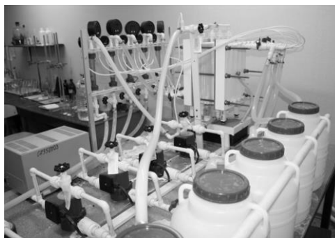
Рис. 1 Лабораторная электромембранная ячейка, собранная в трехкамерном варианте
