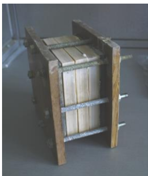
Рис. 1 Лабораторная электромембранная ячейка, собранная в трехкамерном варианте
