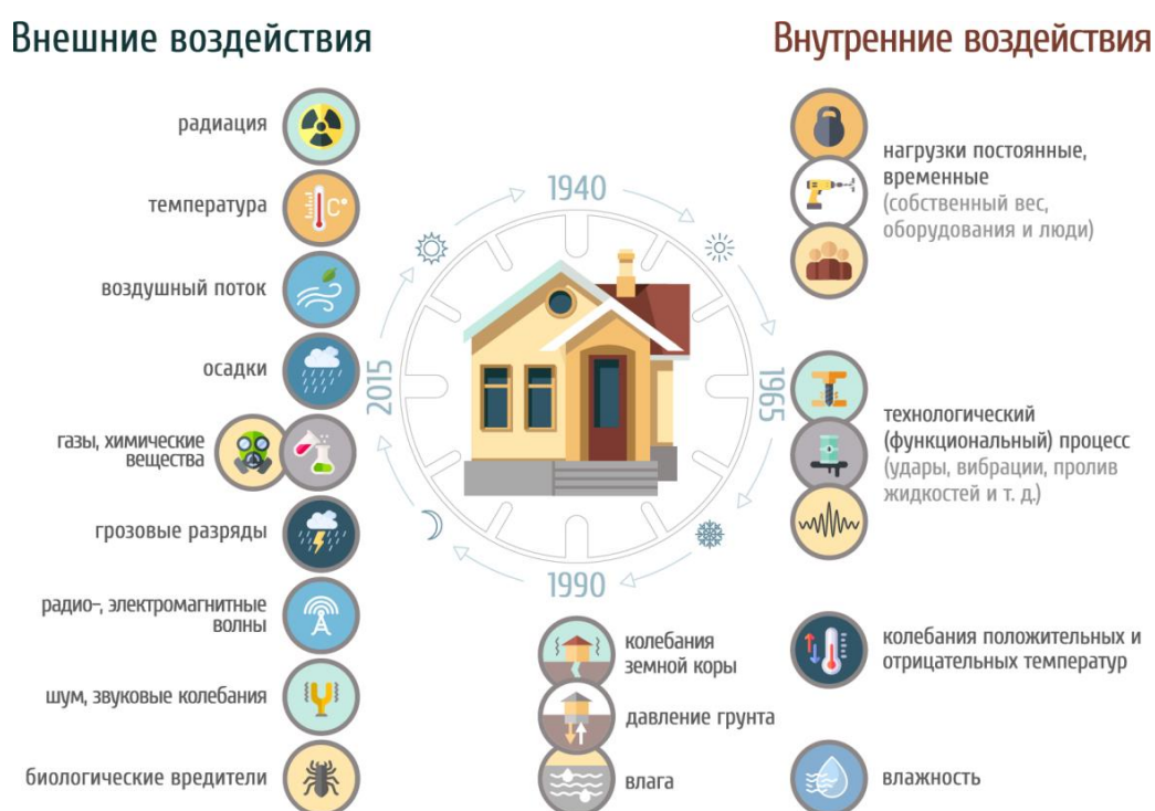
Рисунок 1 – Факторы, воздействующие на строительные конструкции на протяжении всего срока эксплуатации
