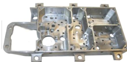
Рисунок 6. Деталь, состоящая из ряда примыкающих друг к другу нежестких элементов
