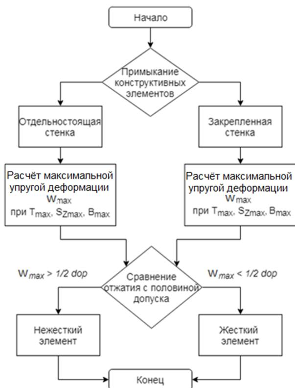
Рисунок 4. Алгоритм выявления нежестких элементов
