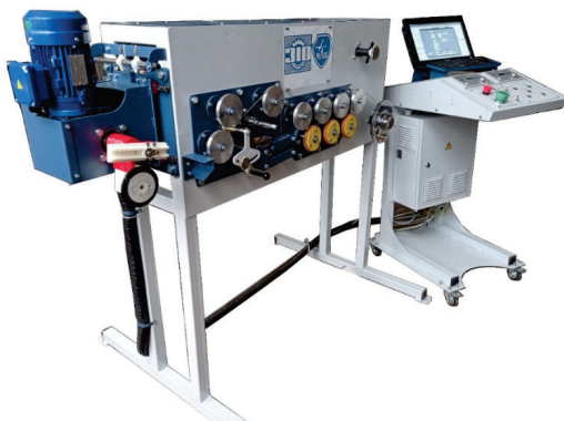
Рисунок 7 - Станок для намотки ВТСП катушек
