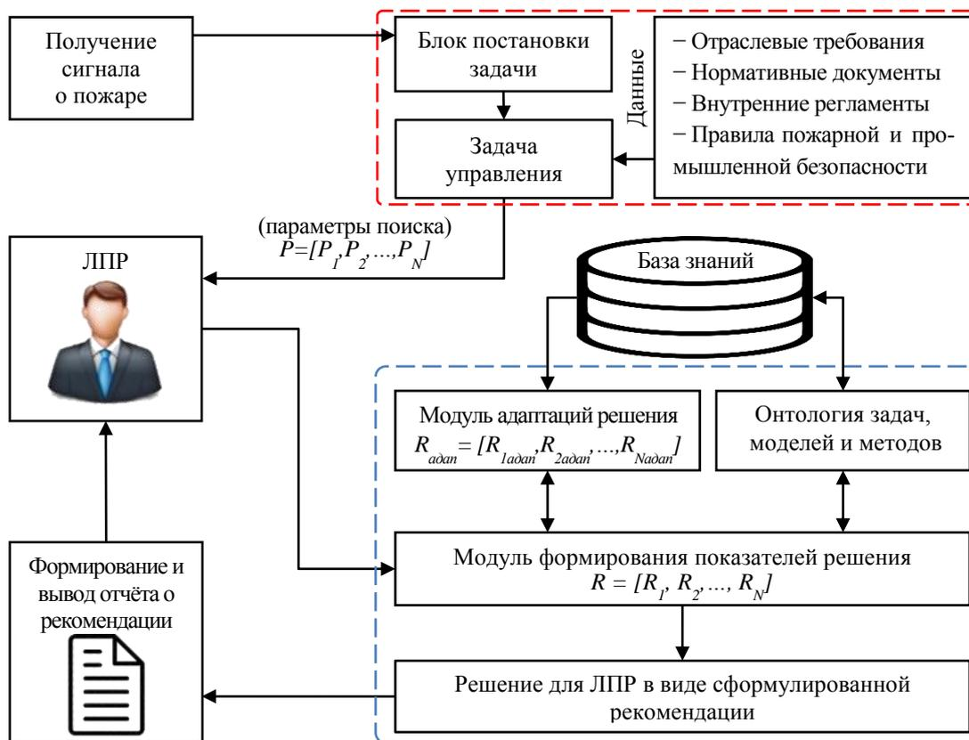
Рисунок 12 – Функциональная схема системы поддержки управления для прогнозирования ресурсов пожарно-спасательных подразделений при реагировании на пожары объектов нефтепереработки
