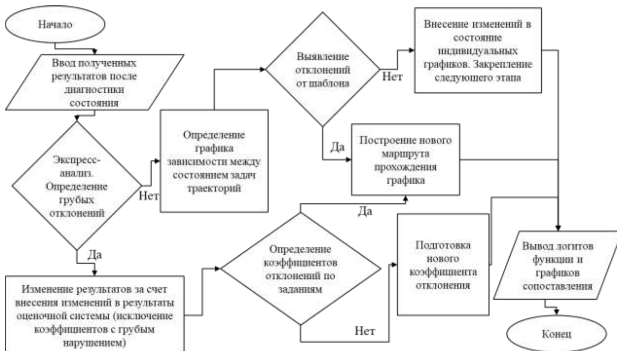
Рисунок 12 – Блок-схема алгоритма корректировки обратной связи
