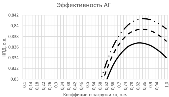
Рисунок 9 — Рабочая характеристика асинхронного генератора
