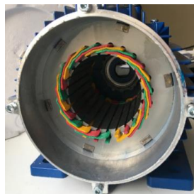
Рисунок 10 — Статор макетного образца МКОС
