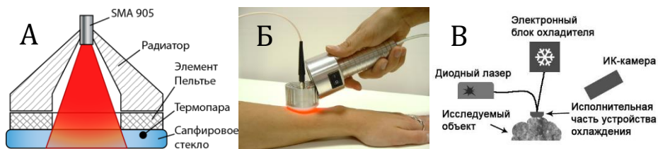
Рисунок 1. А) Принципиальная схема устройства охлаждения. Б) Устройство для контактного облучения внутрикожных опухолей и метастазов с электронной системой охлаждения. В) Схема эксперимента по измерению лазерно-индуцированных тепловых полей.
