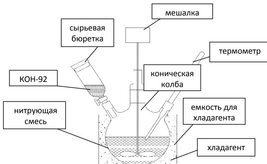
Рисунок 1 – Лабораторная установка синтеза присадки
