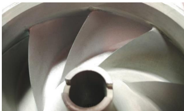
Рис.10. Рабочее колесо ТНА, послужившее прототипом для создания формы экспериментального ЭИ
