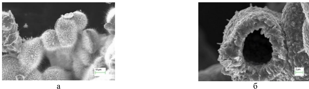
Рисунок 20 - СЭМ изображение морфологии поверхности частиц порошка меди после отжига (а) при T=400^{\circ}\text{C} образцы №1, 2; (б) при T=600^{\circ}\text{C} образец № 2
