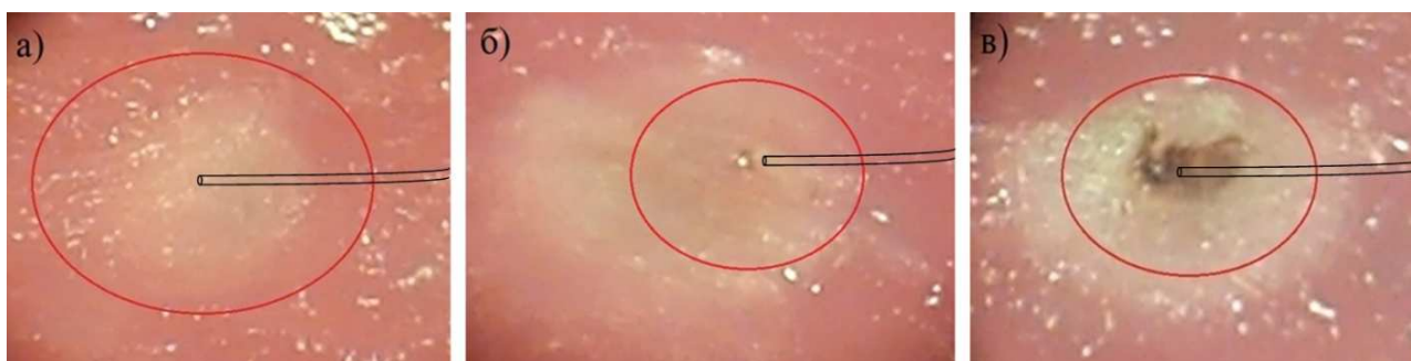
Рис. 9. Процесс изменения поверхности образца свиной мышечной ткани под действием лазерного излучения. Мощность излучения 0.7 Вт. Время воздействия: (а) 3 с, (б) 9 с, (в) 15 с. Схематически показано волокно, подающее излучение. Увеличение 15\times .
