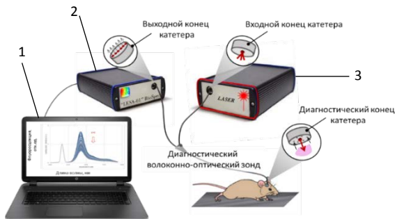
Рисунок 5. Схема экспериментальных исследований работы нейросистемы на лабораторных животных: (1) компьютер с программным обеспечением, (2) спектроанализатор, (3) лазерный источник.
